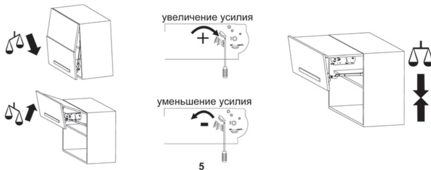
**Регулировка усилия доводчика на закрытие в зависимости от веса фасада**
