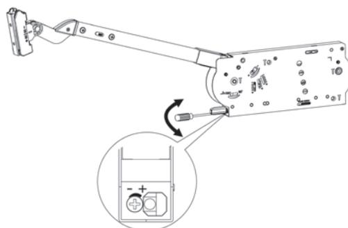
**Регулировка угла открывания фасада**
