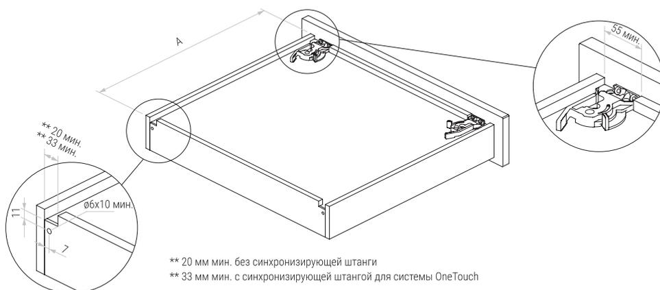
\*\* 20 мм мин. без синхронизирующей штанги
