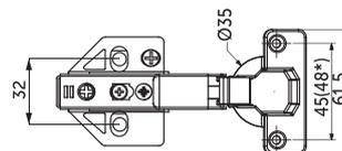
Петля полунакладная с 3D регулировкой Clip-On
